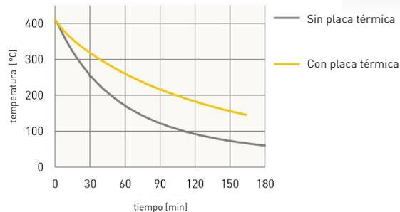
Comparación de la evolución del calor del bloque (placa térmica **sin ventilador**)
